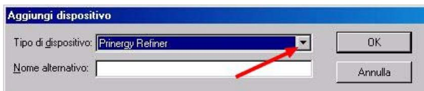
3.6 Nella finestra "Aggiungi dispositivo" assegnare un nome al dispositivo (solitamente useremo il formato lastra che stiamo configurando), nel nostro esempio sarà "1030x770". Confermare con "OK"
